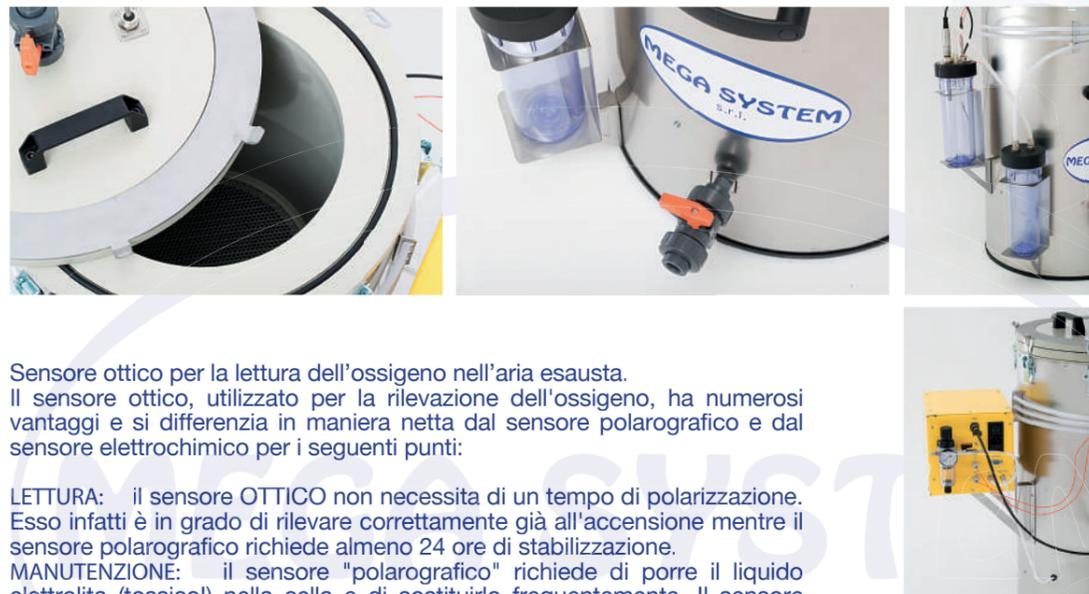
Sensore ottico per la lettura dell'ossigeno nell'aria esausta. Il sensore ottico, utilizzato per la rilevazione dell'ossigeno, ha numerosi vantaggi e si differenzia in maniera netta dal sensore polarografico e dal sensore elettrochimico per i seguenti punti:
